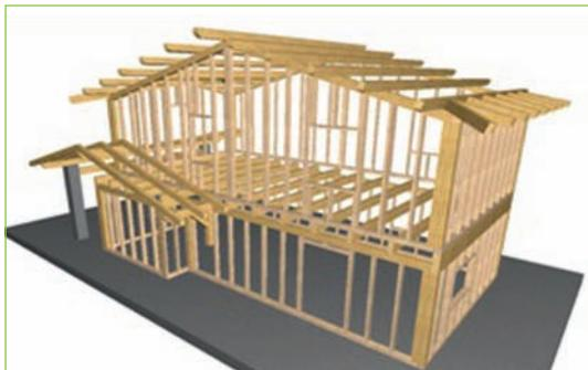
Nel sistema a **TELAIO** l'ossatura portante è composta da montanti disposti a distanza piuttosto ravvicinata a formare il telaio, questo viene rivestito con pannelli per costituire una lastra, internamente isolata, un ulteriore isolamento è realizzato con il cappotto esterno. Vengono impiegate sezioni come da progetto e materiali di alta qualità, connessi mediante apposita ferramenta.
