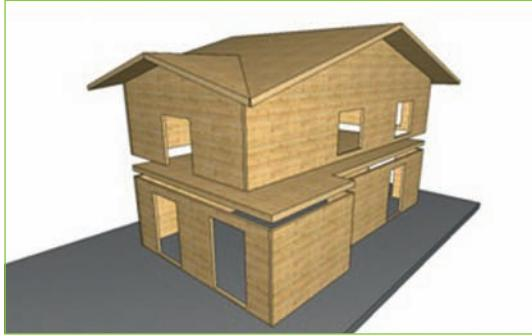
Il sistema **X LAM** è realizzato mediante compensato di tavole ed è caratterizzato dall'impiego di elementi massicci piani multistrato con funzione portante, nei quali le dimensioni lungo entrambi gli assi principali sono di gran lunga maggiori dello spessore. Gli elementi massicci di parete, solaio e copertura sono prodotti in base alle indicazioni di progetto e collegati con sistemi di connessioni metalliche, l'isolamento è tutto esterno.
